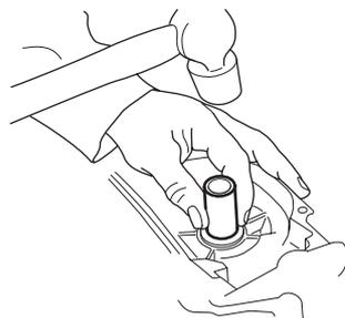
Chauffer les nouveaux paliers dans le carter moteur avec un pistolet à air chaud.
