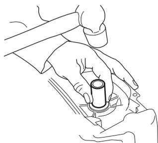
Pour monter le joint, utiliser une douille provenant de 502 50 30-16.
