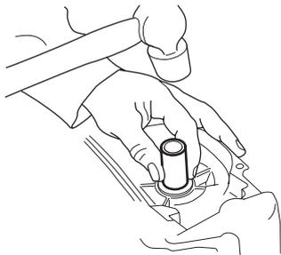
Para montar el anillo de guarnición se utiliza el manguito que se incluye en 502 50 30-16. Un extremo (el de la medialuna) se utiliza para el anillo de guarnición del lado del embrague que se monta al nivel del plano del cárter. El anillo de guarnición en el lado del volante se monta con el lado trasero del manguito. El manguito proporciona la profundidad de montaje adecuada (1,8 mm). Los anillos de guarnición se lubrican con aceite.
