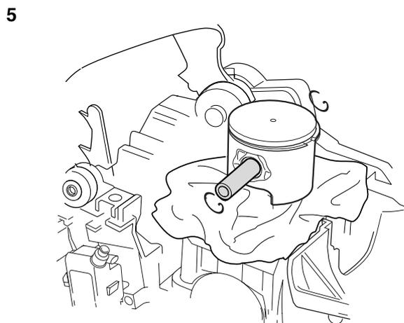
Saque los clips del bulón del pistón y extraiga el bulón. Después, desmonte el pistón.
