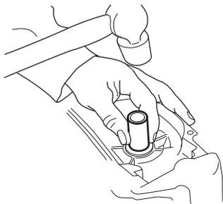
Zur Montage der Dichtungsringe wird eine Hülse verwendet, die zu 502 50 30-16 gehört. Das eine Ende (mit dem Halbmond) wird für den Dichtungsring auf der Kupplungsseite verwendet, der auf gleicher Höhe mit der Kurbelgehäuseebene montiert wird.
