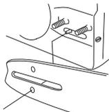
Tendere la catena con la vite apposita e la chiave combinata avvitandola in senso orario. La tensione è corretta quando la catena rimane nella scanalatura intorno alla lama.
