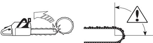
Il contraccolpo avviene sempre lungo il piano di taglio della lama. Di solito il movimento di motosega e lama è verso l'alto e verso l'operatore. Possono tuttavia verificarsi altre situazioni a seconda della posizione della motosega nel momento in cui il settore a rischio viene a contatto con un corpo estraneo.
