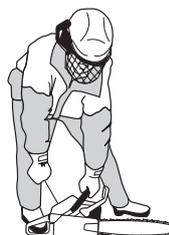
Dato che il freno della catena è ancora inserito il regime del motore deve scendere al minimo il più presto possibile, il che si ottiene disattivando velocemente il fermo del gas. In questo modo si evita di usurare inutilmente la frizione, il tamburo della frizione e il nastro del freno.
