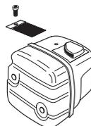
Alcune marmitte sono dotate di una speciale retina parascintille. Se la macchina è dotata di una marmitta di questo tipo, è consigliabile pulire la retina una volta alla settimana. Per un risultato ottimale usare una spazzola di acciaio.
