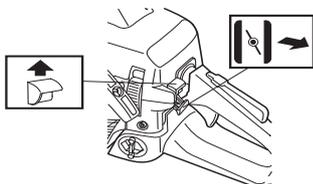
**Ralenti accéléré:** Un ralenti accéléré combiné au starter est obtenu quand la commande est en position de starter.
