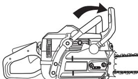
**Démarrage:** Le frein de chaîne doit être activé quand la tronçonneuse est démarrée. Activer le frein en poussant la protection anti-rebond vers l'avant.
