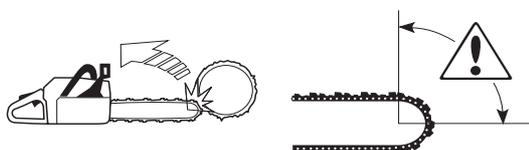
Le rebond se produit toujours dans le plan du guide-chaîne. En général, tronçonneuse et guide-chaîne sont relevés simultanément en direction de l'utilisateur. Néanmoins, la direction du rebond peut varier suivant la position de la tronçonneuse au moment où la zone de rebond du guide-chaîne touche un objet quelconque.
