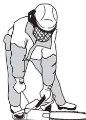
Le frein de chaîne étant encore activé, le régime du moteur doit être mis sur le ralenti le plus vite possible en déconnectant rapidement la gâchette d'accélération. De cette manière, toute usure inutile de l'embrayage, du tambour d'embrayage et de la bande de frein peut être évitée.
