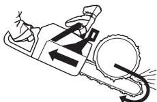
Il importe de résister à la poussée en arrière du guide-chaîne. En effet, si le guide-chaîne est repoussé suffisamment en arrière pour que la zone de rebond du nez se trouve en contact avec l'arbre, un rebond peut se produire.
