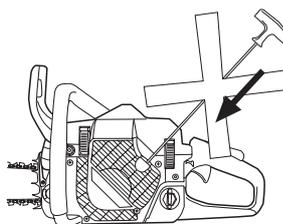
Réinitialiser le frein de chaîne en poussant la protection anti-rebond contre l'étrier de la poignée. La tronçonneuse est maintenant prête à être utilisée.
