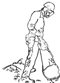
Ne se déplacer qu'avec le tronc entre soi et la tronçonneuse.
