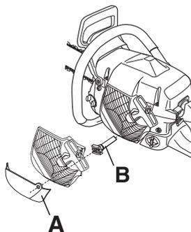
Ces dispositifs permettent de réduire la quantité d'air froid admise et empêchent que de grandes quantités de neige soient aspirées dans le compartiment du carburateur.
