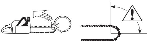
Le tronçonnage avec la partie inférieure de la chaîne, c'est à dire par dessus (de haut en bas), s'appelle méthode "poussée". La tronçonneuse est attirée vers l'arbre et le bord avant de la tronçonneuse devient un appui naturel contre l'arbre. Dans ce cas, l'utilisateur contrôle mieux à la fois sa tronçonneuse et la zone de rebond du nez.
