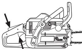
Enfoncer la commande du starter dès que le moteur s'allume et répéter les lancements jusqu'au démarrage. Quand le moteur démarre, accélérer rapidement à fond, ce qui en même temps supprime le ralenti accéléré.
