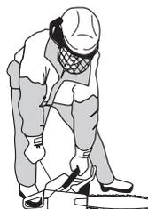
Dado que el freno de cadena todavía está activado, se deben bajar las revoluciones del motor lo antes posible a ralentí, y esto se logra desconectando rápidamente el fiador contra aceleraciones involuntarias. De ese modo, se evita un desgaste innecesario del embrague, del tambor del embrague y de la cinta de freno.
