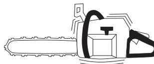
As vibrações a que o utilizador é submetido ao usar a moto-serra, têm sempre origem no contacto "irregular" entre a corrente e a madeira durante a serração.
