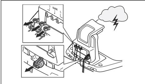
Para reducir el riesgo de daños en los componentes eléctricos del producto y en la estación de carga, recomendamos desconectar todas las conexiones de la estación de carga (suministro eléctrico, cable delimitador y cable guía) si existe riesgo de tormenta eléctrica.
