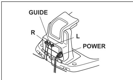
3. Intercambie las conexiones del cable guía y el cable delimitador en la estación de carga.
