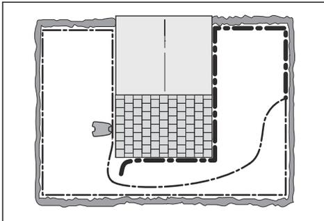
Continúe hasta que solo quede una sección muy corta del cable, que será la diferencia entre una luz verde fija y una luz azul intermitente. Después, siga las instrucciones del paso 5 a continuación.
