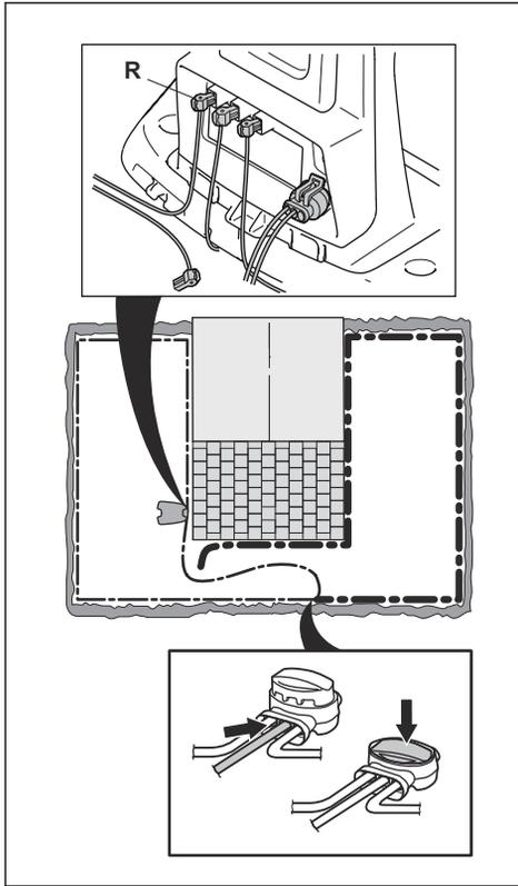
Si la luz indicadora parpadea ahora en amarillo, la rotura está en algún lugar del cable entre el extremo desconectado y el punto donde se conecta el cable nuevo (la siguiente línea negra y gruesa). En ese caso, acerque la conexión del cable nuevo a la punta desconectada (más o menos, en la mitad de la sección del cable que podría estar dañada) y vuelva a comprobar si la luz indicadora está en verde.
