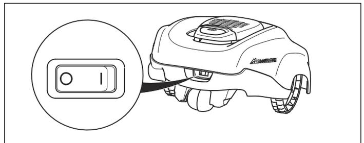
Coloque el interruptor principal en la posición **1** para arrancar el robot cortacésped.
