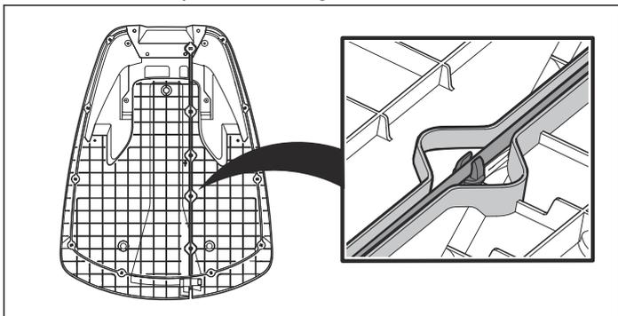
2. Coloque el conector en el cable guía del mismo modo que el cable perimetral, según se indica en *Conexión del cable perimetral en la página 18*. Conéctelo a la clavija pasador de contacto de la estación de carga con la indicación Guide (guía).
