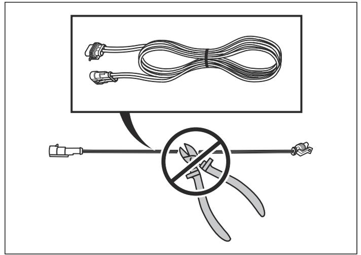
Es posible dejar que el cable de baja tensión cruce el área de trabajo. El cable de baja tensión se debe sujetar al suelo o enterrar, y la altura de corte debe ajustarse de modo que las cuchillas del disco de corte no entren nunca en contacto con él.
