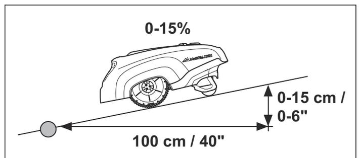
El cable perimetral no debería colocarse a lo largo de una pendiente superior al 15%. Existe el riesgo de que el robot cortacésped tenga dificultades para dar la vuelta en este punto. El cortacésped se detendrá y aparecerá el mensaje de error *Fuera del área de trabajo*. El riesgo es máximo en condiciones de tiempo húmedo porque las ruedas pueden deslizarse sobre la hierba mojada.
