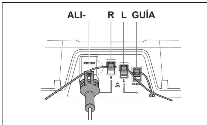
3. Conecte la estación de carga a la fuente de alimentación. Intercambie las conexiones del cable guía y el cable delimitador en la estación de carga.
