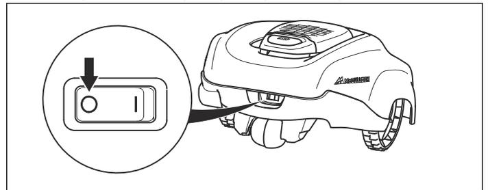
Apague siempre el robot cortacésped mediante el interruptor principal si es necesario realizar trabajos de mantenimiento o si debe sacarse el robot cortacésped del área de trabajo.
