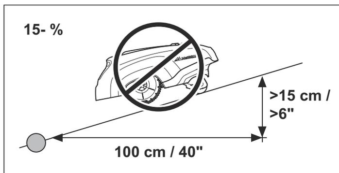
Sin embargo, el cable perimetral puede colocarse por toda la pendiente con una inclinación superior al 15% si hubiera cualquier obstáculo contra el que el robot cortacésped pudiera colisionar, como una valla o un seto espeso.
