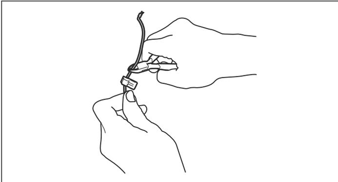
4. Presione el conector sobre la clavija de metal, presione el conector sobre la clavija de contacto, marcada con L (izquierda) y R (derecha), en la estación de carga. Compruebe con cuidado que el conector esté correctamente encajado.
