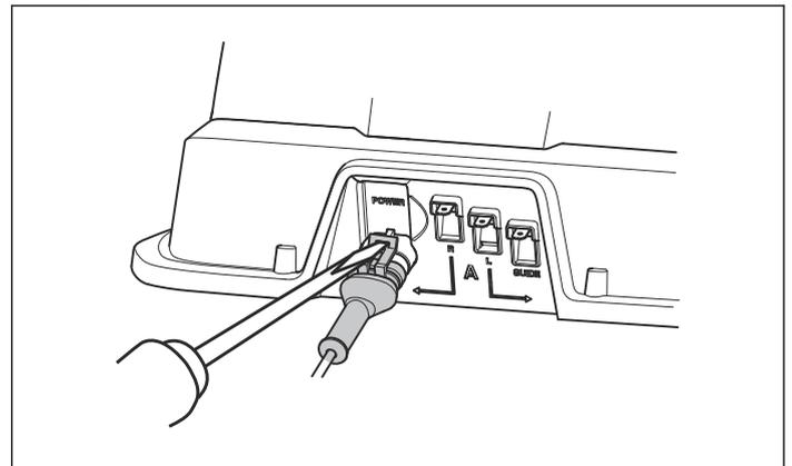
3. Desconecte los contactos del cable delimitador y del cable guía de la estación de carga.
