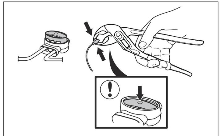
**¡NOTA!** Torcer los cables juntos o un bloque de terminales roscados aislado con cinta aislante no son empalmes adecuados. La humedad del suelo hará que el cable se oxide y tras un tiempo puede producirse un circuito roto.
