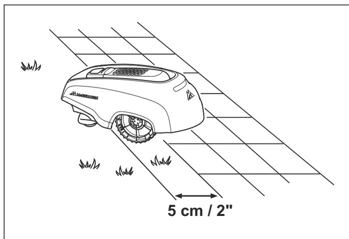
Cuando la zona de trabajo está dividida por un camino de adoquines a la altura del césped, puede permitirse al robot cortacésped pasar por encima. Puede resultar ventajoso colocar el cable perimetral bajo los adoquines. El cable perimetral también puede colocarse en la unión entre adoquines. Asegúrese de que las baldosas están a nivel con el césped para evitar un desgaste excesivo del robot cortacésped.
