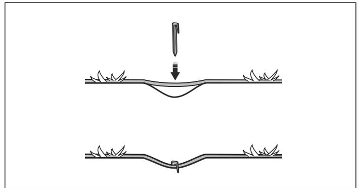
El cable de baja tensión nunca deberá recogerse en un rollo o bajo la placa base de la estación de carga, ya que esto puede interferir con las señales desde la estación de carga.
