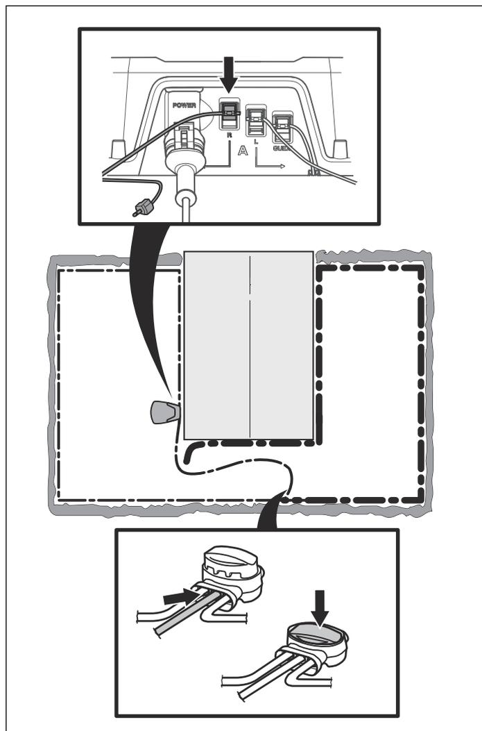
En ese caso, acerque la conexión del cable nuevo al cabo desconectado (más o menos, a la mitad de la sección del cable que podría estar dañada) y vuelva a comprobar si la luz indicadora está en verde o parpadea en amarillo.
