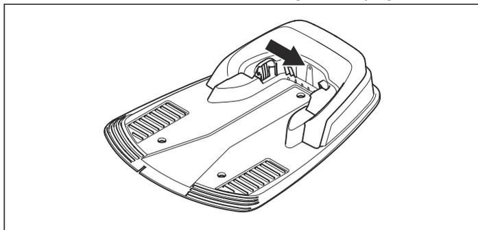
2. Compruebe que las conexiones del cable delimitador a la estación de carga están conectadas correctamente y no están dañadas. Compruebe que la luz indicadora de la estación de carga sigue parpadeando en azul.
