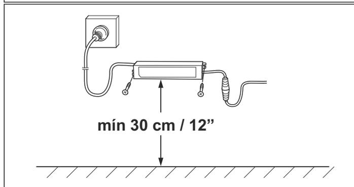
**¡ATENCIÓN!** No se debe cambiar ni manipular ninguna de las piezas de la fuente de alimentación bajo ninguna circunstancia. El cable de baja tensión no se debe acortar ni alargar.
