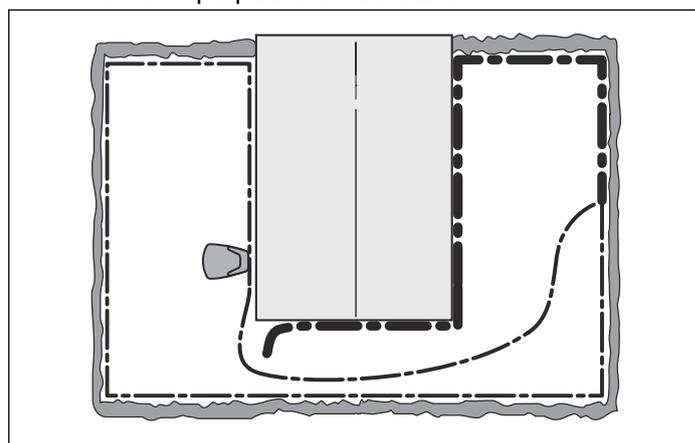
Continúe hasta que solo quede una sección muy corta del cable, que será la diferencia entre una luz azul intermitente y una luz verde fija.
