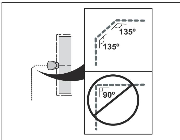
4. Guíe el cable guía hasta el punto del cable perimetral donde un lazo permitirá la conexión del cable guía que se añadió previamente.
