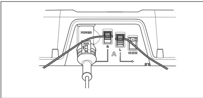
**¡NOTA!** El conector derecho se debe conectar a la clavija metálica derecha de la estación de carga; el cabo del cable izquierdo, al conector izquierdo.
