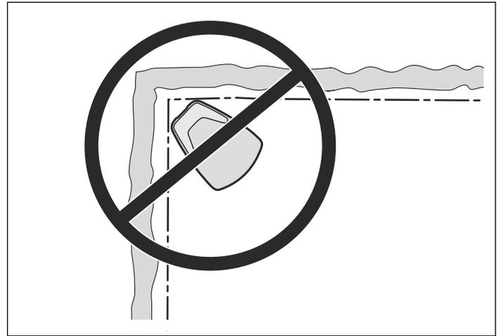
La estación de carga debe colocarse en una superficie totalmente nivelada. El extremo delantero de la estación de carga debe encontrarse como máximo 3 cm/1,2" más alto que el extremo trasero. El extremo delantero de la estación de carga nunca debe encontrarse a una altura inferior que el extremo trasero.
