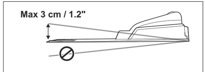
La estación de carga no debe estar colocada de modo que pueda doblarse su placa base.
