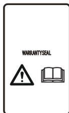
El chasis tiene componentes sensibles a descargas electrostáticas (ESD). Además, el chasis es una pieza importante del diseño del robot cortacésped y se debe volver a sellar de manera profesional. Por este motivo, el chasis solo podrá ser abierto por técnicos de mantenimiento autorizados. Un sello roto puede invalidar la totalidad o parte de la garantía.
