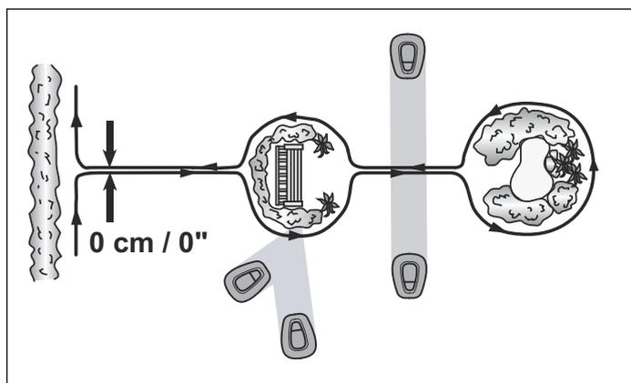
Los obstáculos que pueden resistir una colisión, como árboles y arbustos con una altura superior a 15 cm/6", no necesitan ser demarcados por el cable perimetral. El robot cortacésped dará la vuelta cuando colisione con este tipo de obstáculo.
