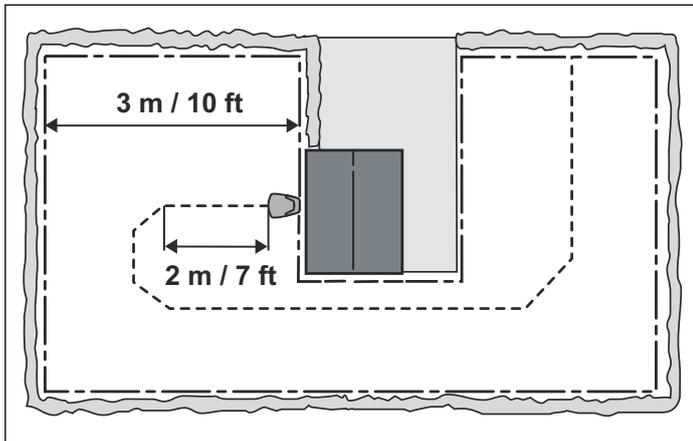
No sitúe la estación de carga en espacios reducidos del área de trabajo. Debe haber un cable perimetral de al menos 1,5 m/5 ft de longitud extendido hacia la derecha y hacia la izquierda de la estación de carga. El cable se debe colocar recto y hacia el exterior, desde el extremo trasero de la estación de carga. Si se elige cualquier otra ubicación, es posible que el robot cortacésped entre de lado en la estación de carga y tenga dificultades para acoplarse.
