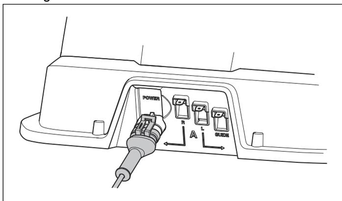
3. Conecte el cable de la fuente de alimentación a una toma de corriente de 100-240V. Si la fuente de alimentación está conectada a una toma de corriente exterior, dicha toma debe ser apta para el uso en exteriores.
