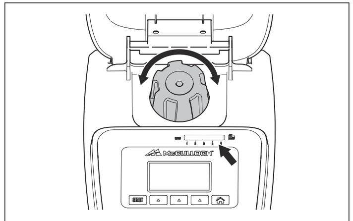
**Aclaración::** Durante la primera semana tras una nueva instalación, la altura de corte se debe configurar como Máx, para evitar dañar el cable de lazo. Después, la altura
