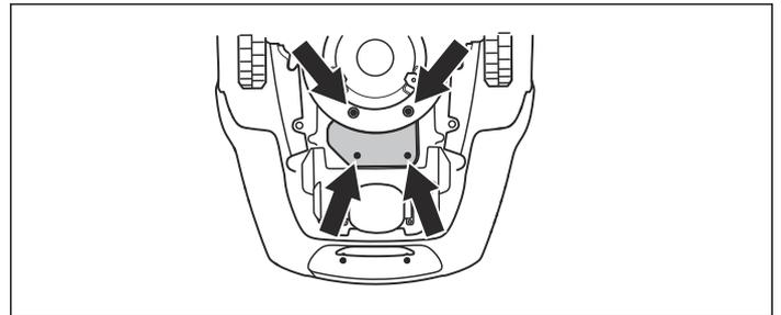
6. Desenrosque el tornillo del soporte de la batería y retire el soporte.
