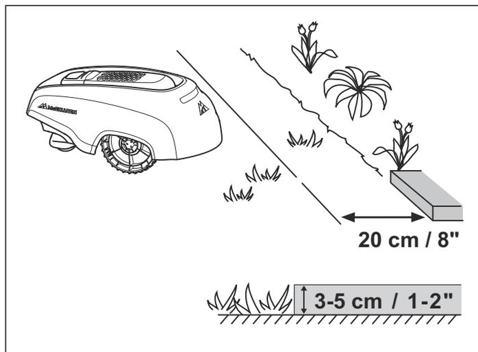
No se cortará el césped de unos 12 cm/5" junto a los bordillos o zanjas.
