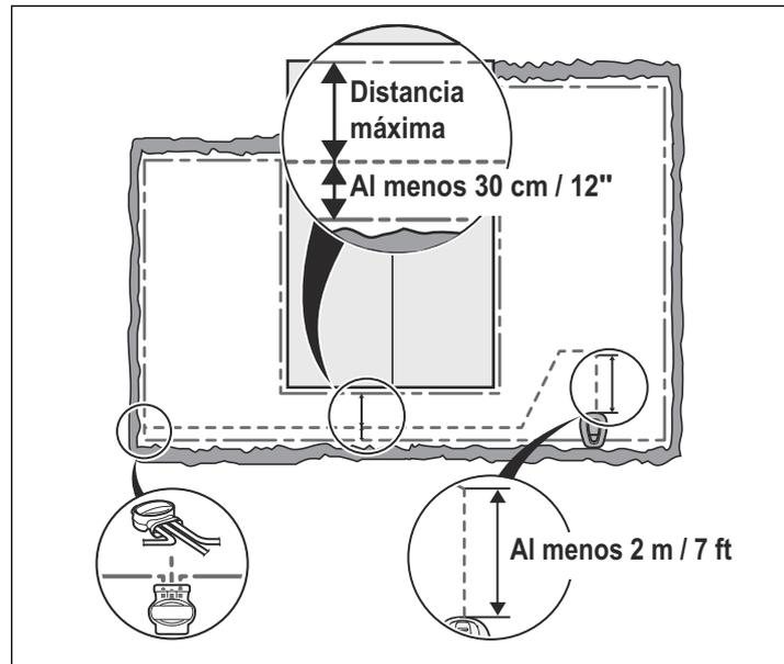
Al igual que el cable perimetral, el cable guía se puede sujetar con estacas o colocarse bajo tierra.
