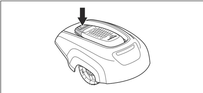
El panel de control de la parte superior del robot cortacésped es donde puede modificar todos los ajustes de este. Abra la tapa del panel de control pulsando el botón **STOP**.
