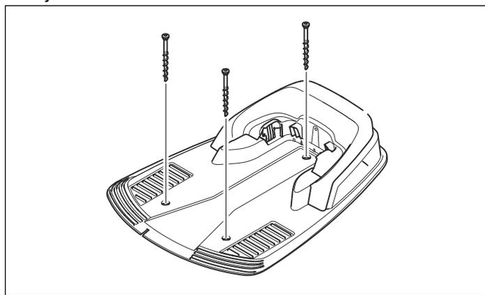
**¡NOTA!** Está prohibido perforar más orificios en la placa de la placa base. Solo los orificios existentes pueden usarse para fijar la placa base al suelo.
